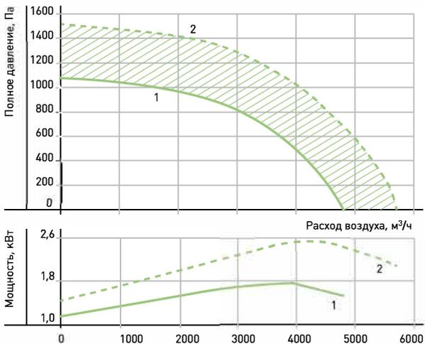
1 – характеристика на номинальных оборотах без использования частотного регулятора (n ном=2840 мин-1)
