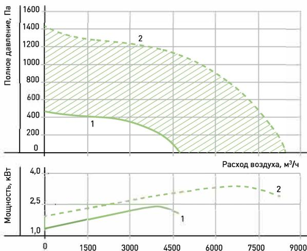
1 – характеристика на номинальных оборотах без использования частотного регулятора (n ном=1410 мин-1)
