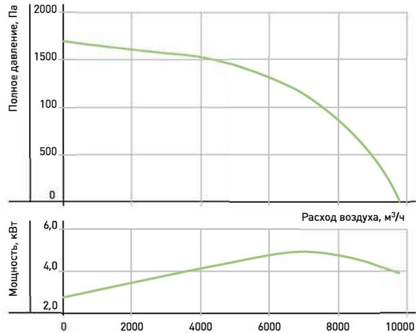
1 – характеристика на номинальных оборотах без использования частотного регулятора ( $n_{nom}=1435$  мин-1)
