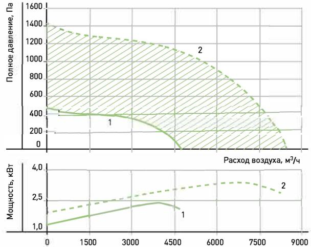
1 – характеристика на номинальных оборотах без использования частотного регулятора (n ном=1410 мин-1)
