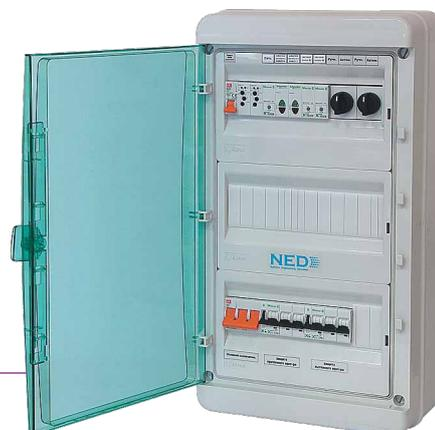
Используется для пуска и защиты трёхфазных вентиляторов (380В), не оснащенных термоконтактами (или термисторами). Защита вентиляторов от перегрузки обеспечивается применением токоограничивающих автоматов. В щит управления установлено устройство плавного пуска двигателя мощностью от 4 до 45кВт (типа UPP – переключение «звезда – треугольник»). Обеспечивается защита от короткого замыкания.
